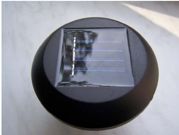
Bild 2 Der obere Leuchtenteil mit Solarpanel
