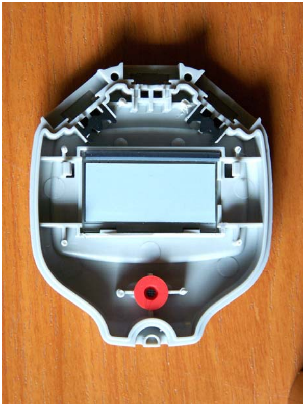
Bild 4 Vorderseite ohne Leiterplatte
