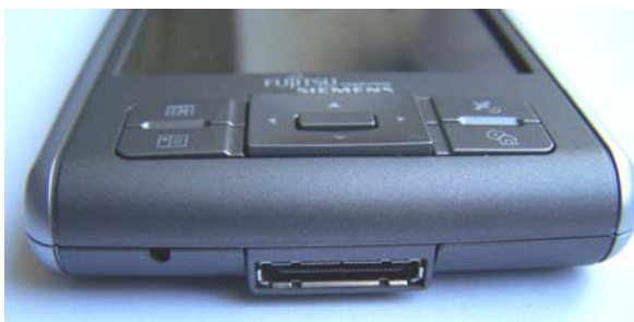
Bild 5 Die 26-polige Universalbuchse des Fujitsu Siemens Pocket Loox N560
