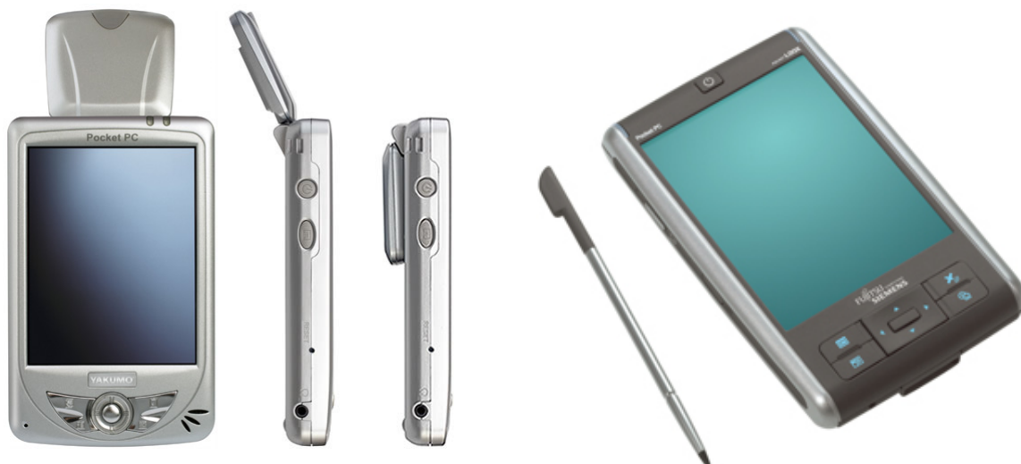
Bild 1 Der Yakumo Delta 300 GPS mit seinem charakteristischen ausklappbaren GPS-Empfänger (Foto Yakumo)
