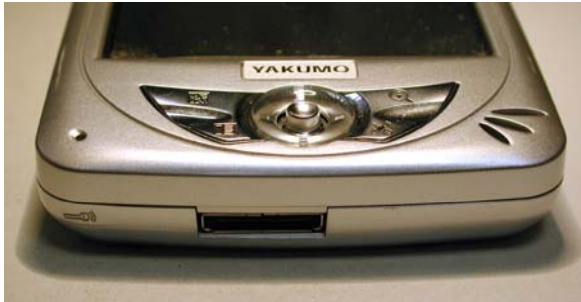
Bild 3 Die 22-polige Universalbuchse des Yakumo Delta 300 GPS
