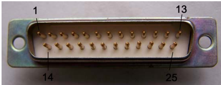
Bild 3 25-poliger SUB-D-Stecker mit Pinbelegung
