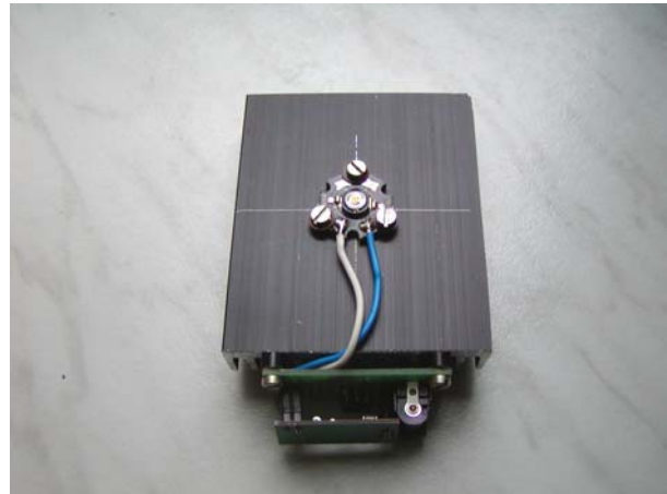
Bild 12 3W-LED mit Miniboard und Stromversorgungs-Buchse auf Kühlkörper montiert
