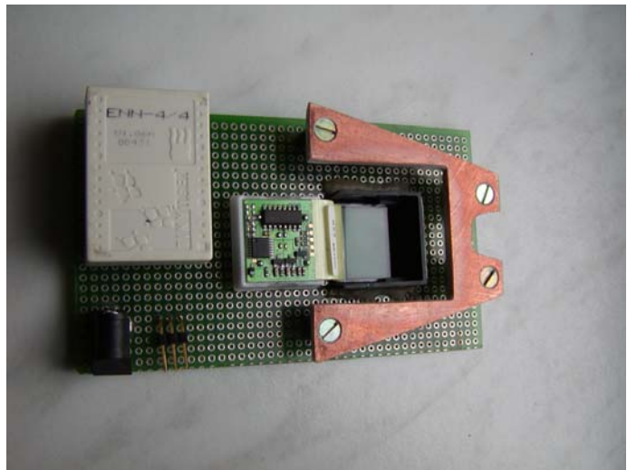
Bild 10 ein Beispiel für die Einbindung eines grafischen Displays DA 6432 B in ein anderes Projektorsystem
