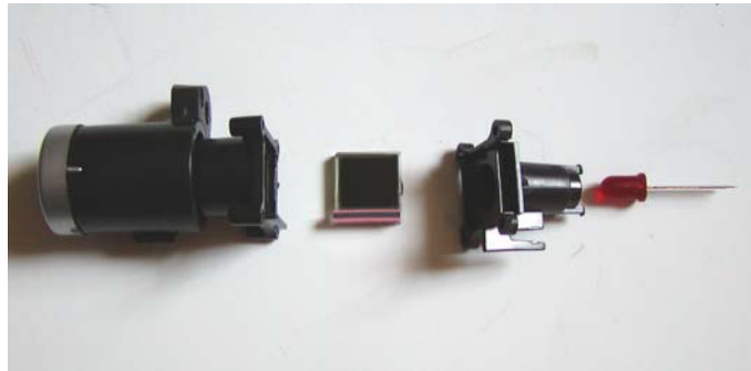
Bild 2 die Projektionseinheit mit LED, LCD-Chip, Objektiv (von rechts nach links)
