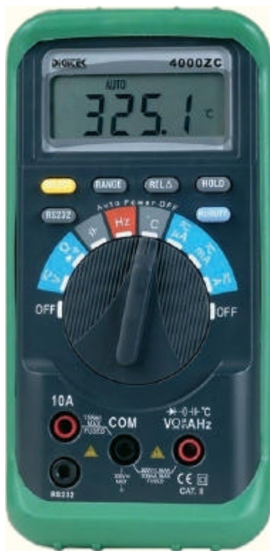
Bild 1 Das DT-4000ZC von Digitek mit 4000 Counts (Anzeige max. 3999)
