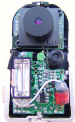
Bild 3 Die Vorderseite mit Objektiv, Blitzröhre und Mikrofon
