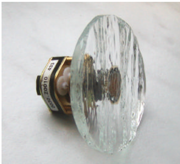
Bild 9 Reliefglasscheibe auf Getriebe-Motor montiert
