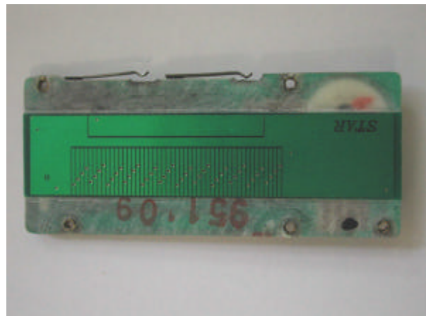
Bild 4 auf der Rückseite sind die eigentlichen kapazitiven Meßsensoren erkennbar
