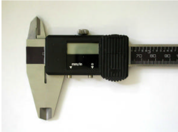
Bild 1 So sieht ein typischer digitaler Meßschieber aus
