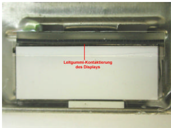
Bild 5 das Display mit seiner Leitgummi-kontaktierung
