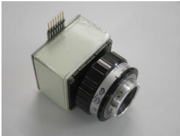
Bild 5 so hat der Autor seine Linienkamera gebaut...
