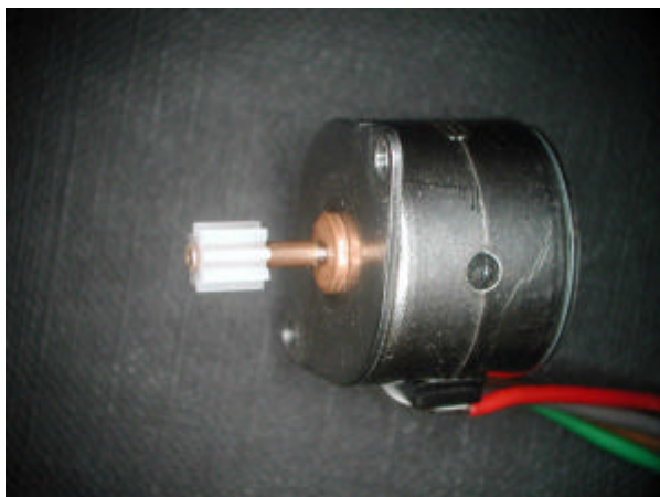
Bild 3 Mit einer kleinen Metallhülse oder Schrumpfschlauch passen Sie das Ritzel an die Motorwelle an
