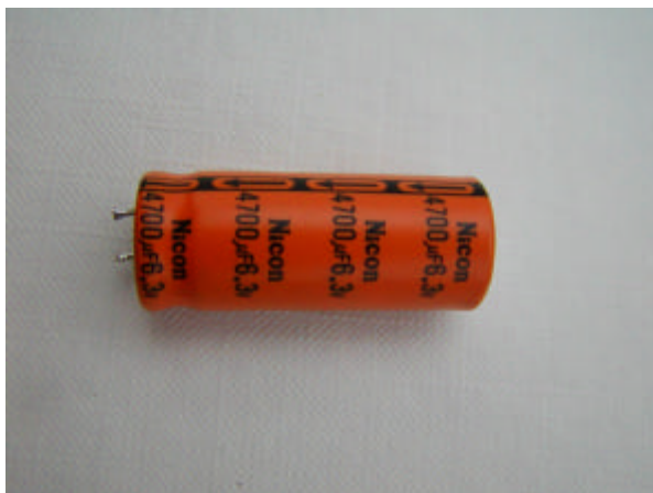
Bild 1 Traditioneller Elektrolytkondensator 4700 \mu F / 6,3 V
