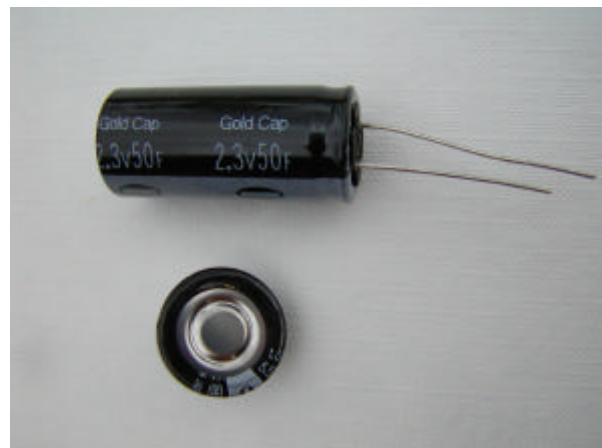
Bild 2 Standard-GoldCap ® 1 F / 5,5 V mit 30 \Omega Innenwiderstand (unten) und Hochleistungs-GoldCap ® 50 F / 2,3 V mit 0,1 \Omega Innenwiderstand von Panasonic (oben)
