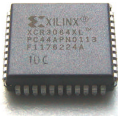
Bild 2 Der XCR3064XL im 44-poligen PLCC-Gehäuse
