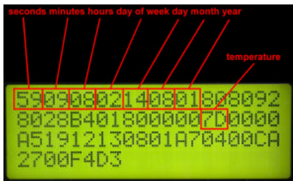
Bild 8 die ersten 32 Bytes aus dem DS1616
