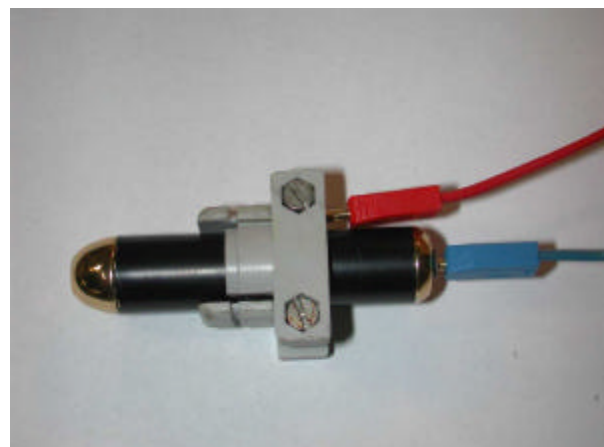
Bild 6 modifizierter Laserpointer mit externer Spannungsversorgung
