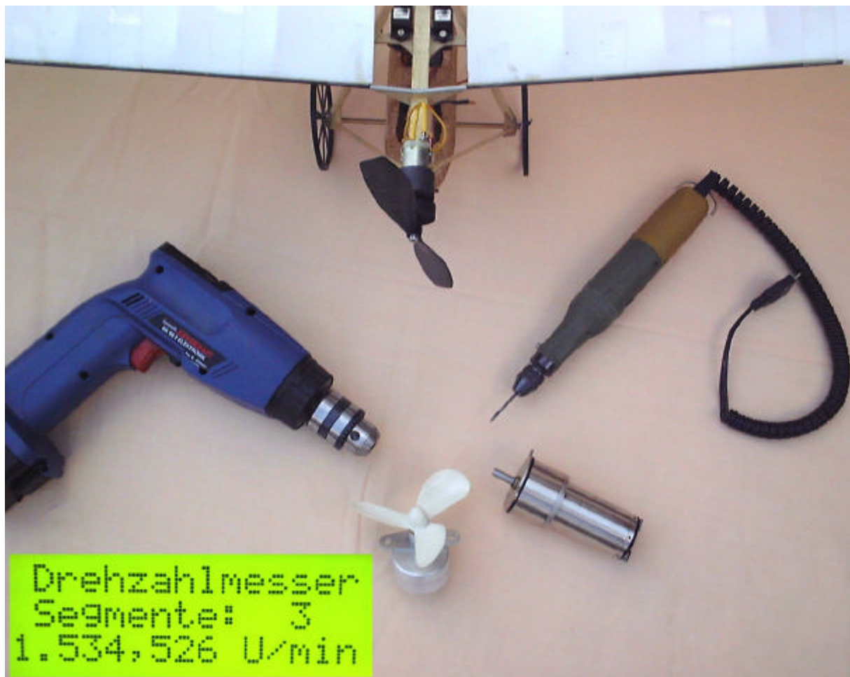
Bild 1 mit wenig Hard- und Software mißt der BASIC-Tiger die Drehzahl verschiedenster Objekte
