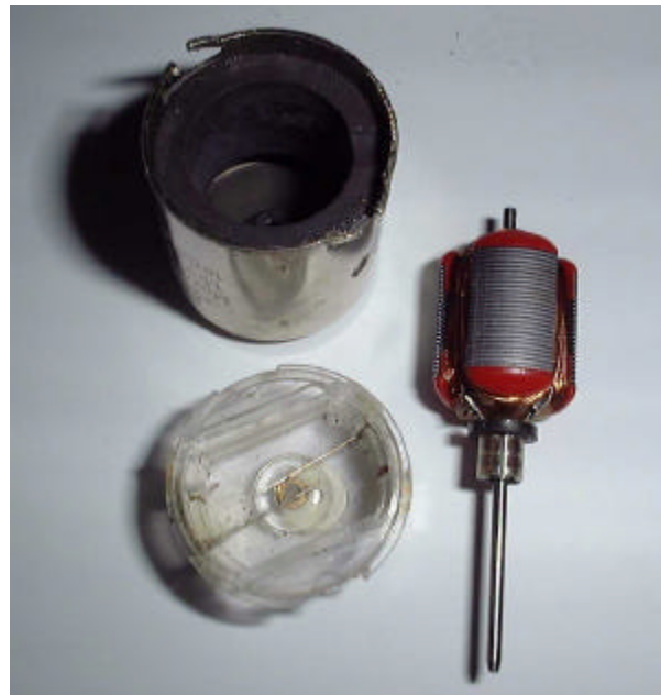
Bild 2 Aufbau dieser Motoren, unten die beiden „Kohlebürsten“, rechts der Anker mit Kommutator, oben der ringförmige Permanentmagnet
