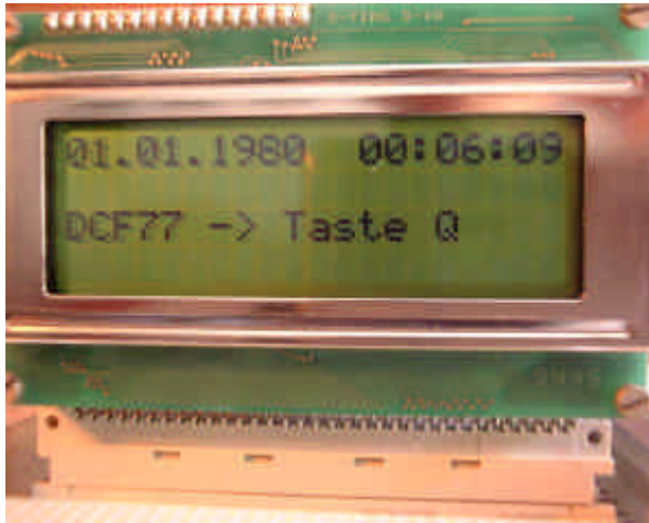
Bild 4 BASIC-Tiger® mit „innerer Uhr“
